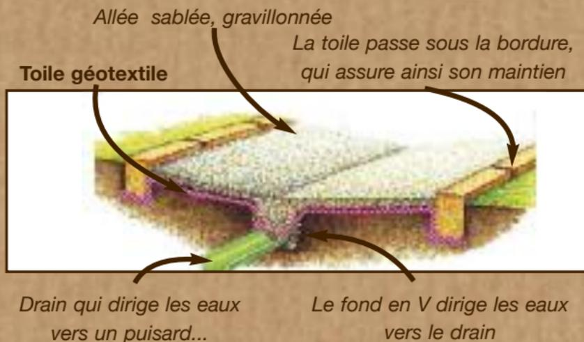
La toile géotextile posée sous le sable ou les gravillons, empêche les herbes indésirables de pousser et laisse pénétrer l'eau.
